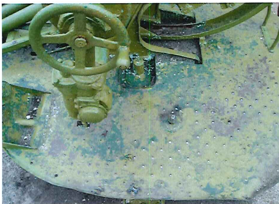
Иллюстрация №28 Вид части поворотной платформы с приводом регулировки угла наклона орудия.
